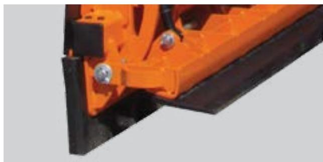
**Doppio coltello di raschiamento neoprene + acciaio alta resistenza all'abrasione, durezza HBW 400 bonificato.**
