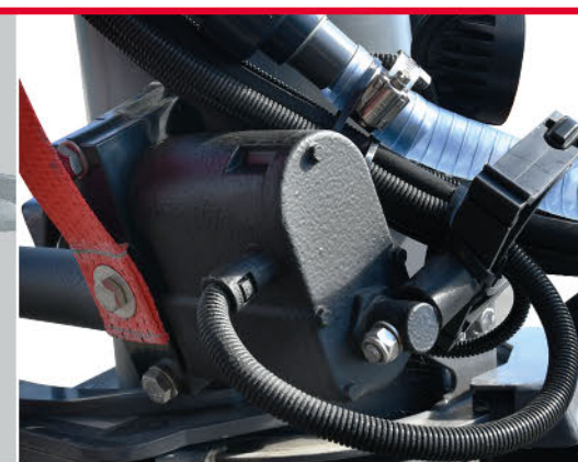
ESBV - elektrische Streubildverstellung (optional) Mit leistungsstarkem Servomotor und Potentiometer für die symmetrische/asymmetrische Verstellung des Streubildes. Wasserdicht nach IP 67.
