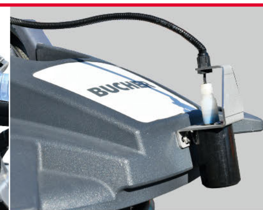
ESK - elektronische Streukontrolle (optional) Berührungslose Infrarottechnik zur Überwachung der Streuung. Das Gehäuse ist wasserdicht nach IP 67.
