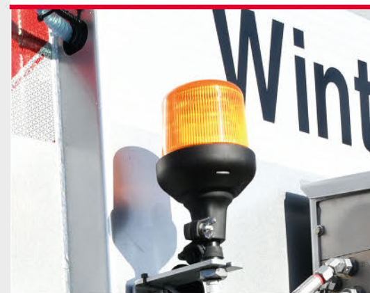
Rundumkennleuchte LED (optional) Am Heck des Streugerätes angebracht zur besseren Sichtbarkeit und Warnung anderer Verkehrsteilnehmer.
