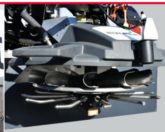
BrineStar® (optional) Bei ECO FS 100 / 12 Meter wird unterhalb des Streutellers die Streueinheit BrineStar® adaptiert. Die Verteilung der Sole erfolgt über BrineStar® von >8 - 12 Meter.
