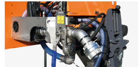
Pumpeneinheit Feuchtsalz (optional) Bestehend aus Solepumpe, Filter, Umschalhahn und C-Anschluss, Verrohrung aus Edelstahl.
