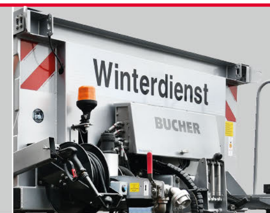
Winterdienst- und Warnmarkierung (optional) Retroreflektierendes Material gemäß DIN 30710.
