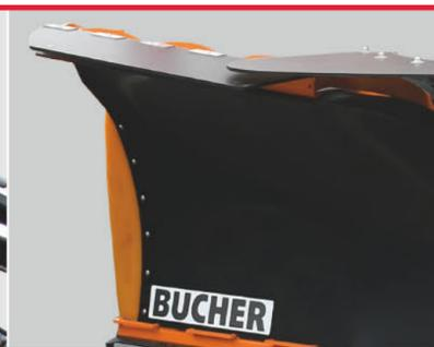
**Schneestaubschutz und PU-Kantenschutz**
