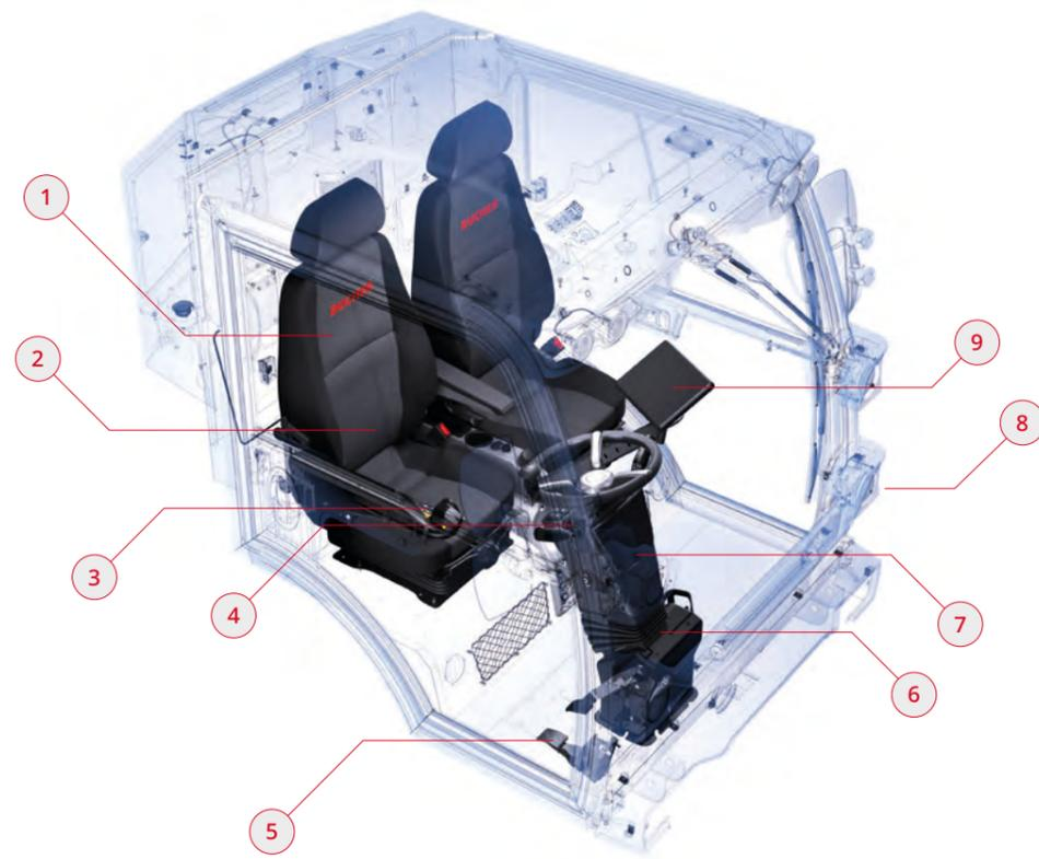
**1** Due sedili di ottima qualità con poggiatesta e cinture a tre punti sia per il conducente che per il passeggero offrono un confort elevato in totale sicurezza
