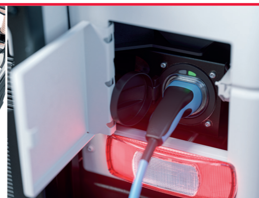
Caricabatterie a bordo da 22 kW
