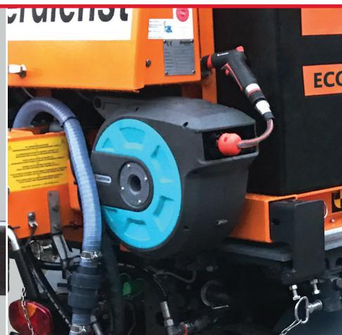
**Gießschlauch mit Handpistole und Schlauchtrommel** (optional)
