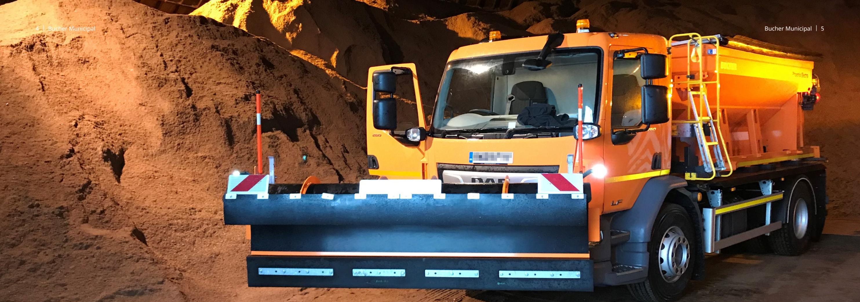
Tre spargitori idraulici equivalenti e tre spargitori elettrici sono stati testati in operazioni invernali dal vivo. La telematica dei camion ha monitorato il consumo di carburante durante i test e i risultati hanno mostrato chiaramente una differenza significativa nelle cifre tra i veicoli con spargitori idraulici ed elettrici.
