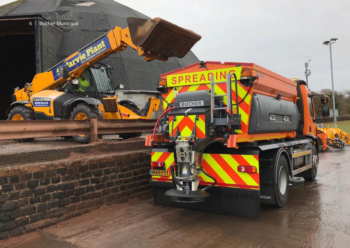
tore in dotazione. Poiché lo spargitore è un'unità indipendente, può essere montato su qualsiasi tipo di telaio, in modo permanente o come unità smontabile su camion standard. All'interno della flotta di noleggio di Bucher Municipal UK, la UniQa Electra è montata su telai Euro 6, consentendo ai clienti di testare la futura tecnologia di spandimento ed essendo in grado di integrarsi con la loro flotta esistente.
