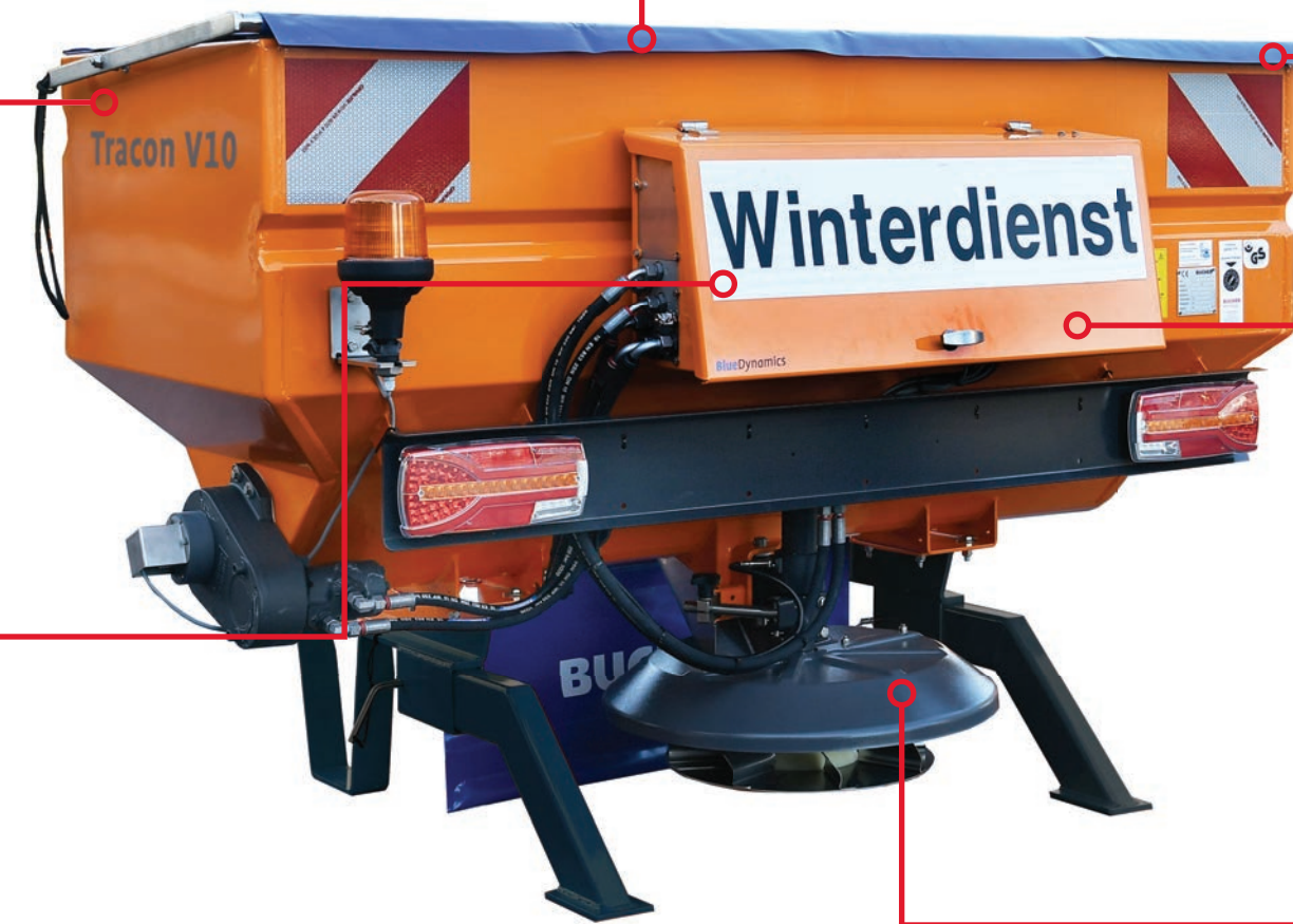
Bestehend aus einem Edelstahl-Streuteller mit speziellem Kunststoffkegel, Abdeckschirm aus hochverschleißfestem Kunststoff. Streubreite 2 bis 8 Meter.
