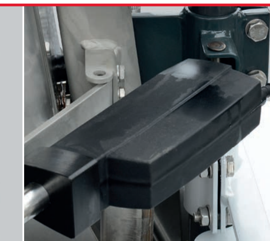
ESBV - elektrische Streubildverstellung (optional) Mit leistungsstarkem Servomotor und Potentiometer für die symmetrische/asymmetrische Verstellung des Streubildes. Wasserdicht nach IP 67.
