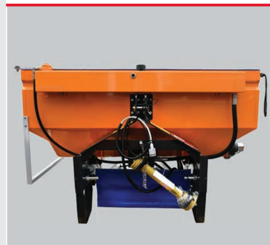
Eigene Hydraulikversorgung (optional) Mit diesem System wird der Streuautomat über die Zapfwelle des Trägerfahrzeuges betrieben. Enthalten ist der Hydrauliktank inkl. Einfüll-, Belüftungs- und Rücklaufilter, Hydraulikpumpe, Getriebe, Hydraulikschläuche sowie die Gelenkwelle.
