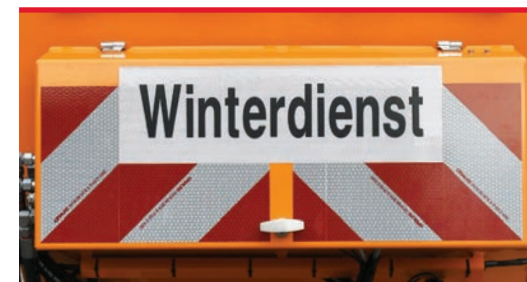
Winterdienst- und Warnmarkierung (optional) Retroreflektierendes Material gemäß DIN 30710.
