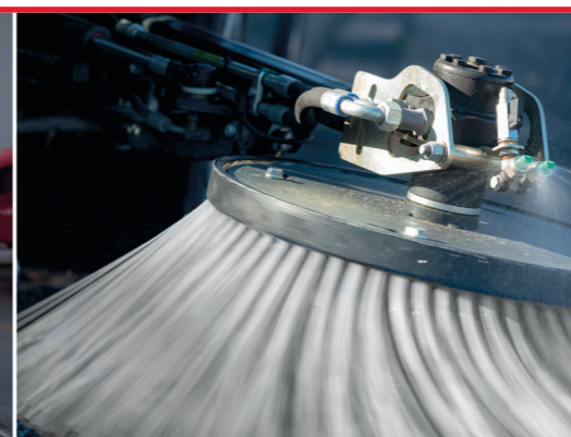
Verneblerdüsen zur Staubbündung
