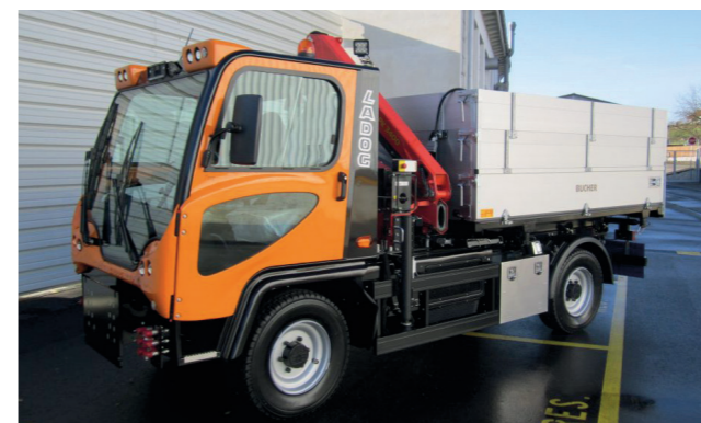
Montage grue arrière cabine
