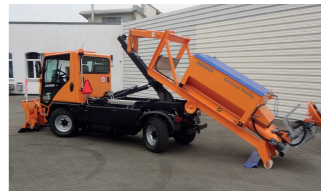
Bras de levage à crochet
