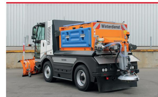
Pour le service de déneigement et de dégivrage, la CityCat 5006 de Bucher Municipal est équipée d'un chasse-neige qui est monté sur la même plaque de montage que le balai avant et commandé par le joystick pour le balai avant. Un épandeur (1.8 m<sup>3</sup>) capable de manipuler du sel humide est également disponible.
