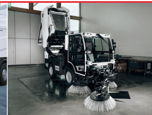
2 m 3 , einfach zu reinigender Kehrgutbehälter
