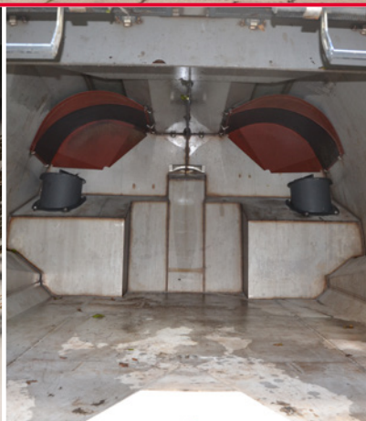
Easiclean* Kan sluttes til en brandhane m. henblik på indvendig spuling af beholderen og rengøring af udblæsningskanalen samt området bag indgangsrørene.
