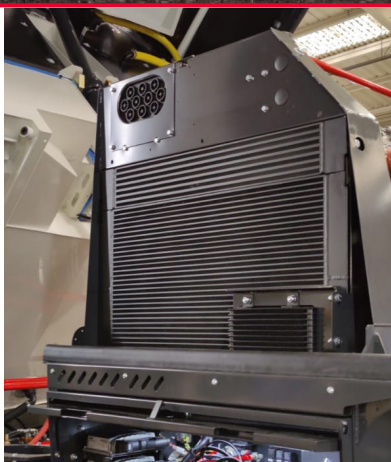
Kombikøler Enkelt tredobbelt kølepakke med forbedret køling og lettere rengøring.
