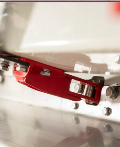
Låsemekanisme i baglågen Robust dobbelt låsemekanisme sikrer tæt tillukning og forebygger utætheder.
