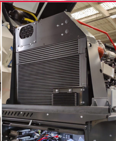
Kombikøler Enkelt tredobbelt kølepakke med forbedret køling og lettere rengøring.
