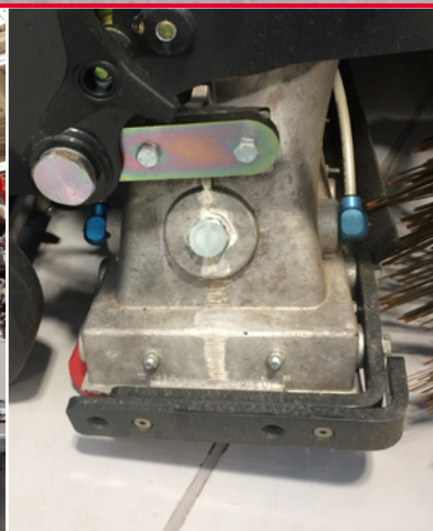
Robust mundstykke* Muligheden for tilvalg af ekstraudstyr i form af robuste hjul og kollisionssikring til sugemundstykket reducerer risikoen for beskadigelse, og forlænger hjulenes levetid.
