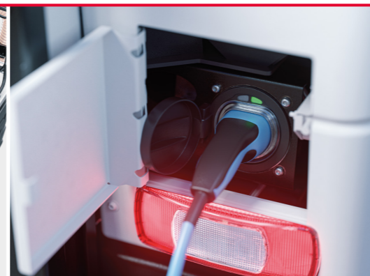
22 kW integreret ladeapparat
