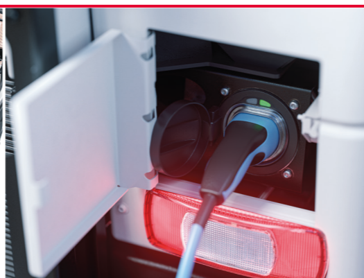
Caricabatterie a bordo da 22 kW
