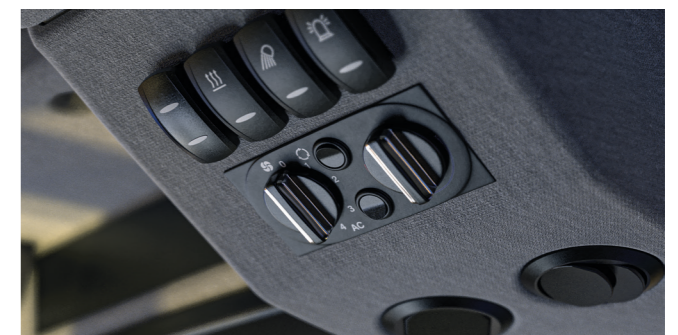
Bedien- und Überwachungseinrichtungen Alle Schalter sind ausserdem leicht erreichbar an der Dachkonsole mit den Bedienelementen der Klimaanlage angeordnet.
