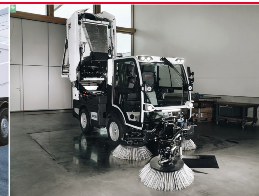
2 m³, einfach zu reinigender Kehrgutbehälter
