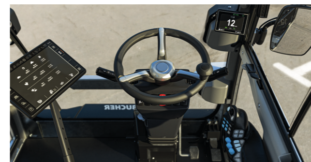
Kabine Komfortabel gefederte, schallgedämpfte ROPS getestete Aluminium-Kabine. Frontscheibe aus wärmedämmendem, gewölbtem, reflexionsarmem Sicherheitsglas.
