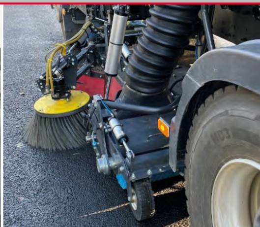
200 mm BroomVak Seitenschieber Ermöglicht ein zusätzliches seitliches Verschieben des Saugmunds und der Tellerbesen um 200 mm für eine grössere Kehrbreite.
