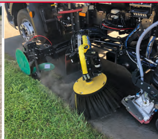
Option de disque de coupe Pour réduire l'envahissement du gazon sur les routes sans revêtement et assurer une coupe nette des accotements.
