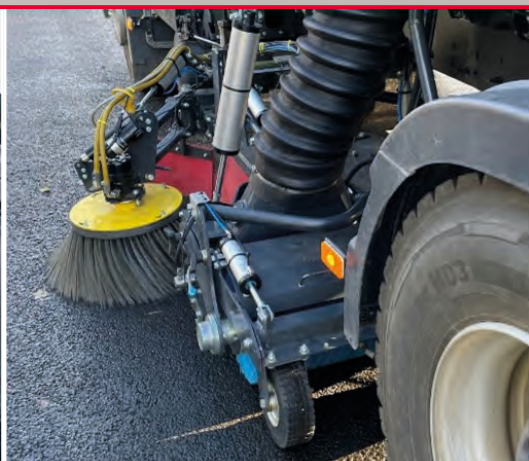
Broomvak coulissant de 200 mm Permet un coulissement supplémentaire de 200 mm de la buse et du balai latéral pour une plus grande largeur de balayage.
