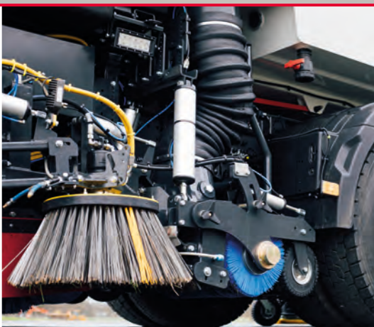
Equipement Broomvak Pour un ramassage à haute vitesse. La conception de balai derrière la buse permet aussi un ramassage à une puissance de turbine réduite pour des applications moins exigeantes.
