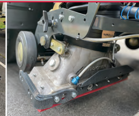
Buse renforcée Pour les applications lourdes. La roue, le pare-chocs et le bras de buse sont plus robustes.
