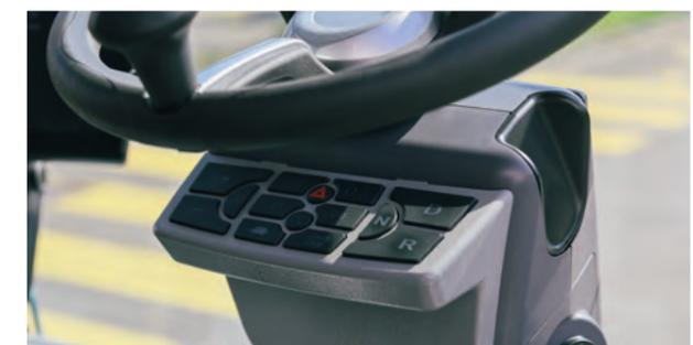
**Pannello di controllo sul piantone dello sterzo**
