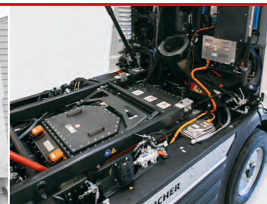
137 kWh Pack de batteries Bucher
