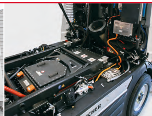
Paquete de baterías Bucher de 137 kWh
