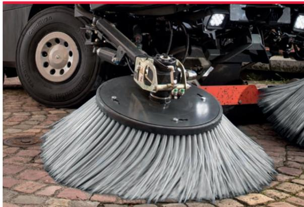
Los brazos de los cepillos incluyen amortiguadores de impactos en la parte delantera y una amortiguación hidráulica en la parte lateral para reducir los costes debidos a los daños. Un «pasador de cizallamiento», que puede ser sustituido fácilmente por el operario, protege los brazos de los cepillos y el chasis, lo que a su vez evita costosas reparaciones.
