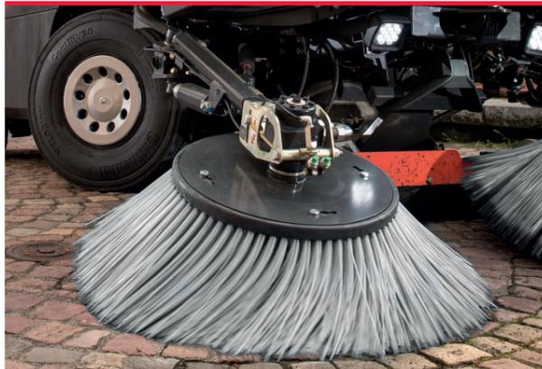
Die Besenarme sind mit vorderen Stossdämpfern und seitlicher hydraulischer Stossdämpfung zur Verringerung von Schadenskosten ausgestattet.
