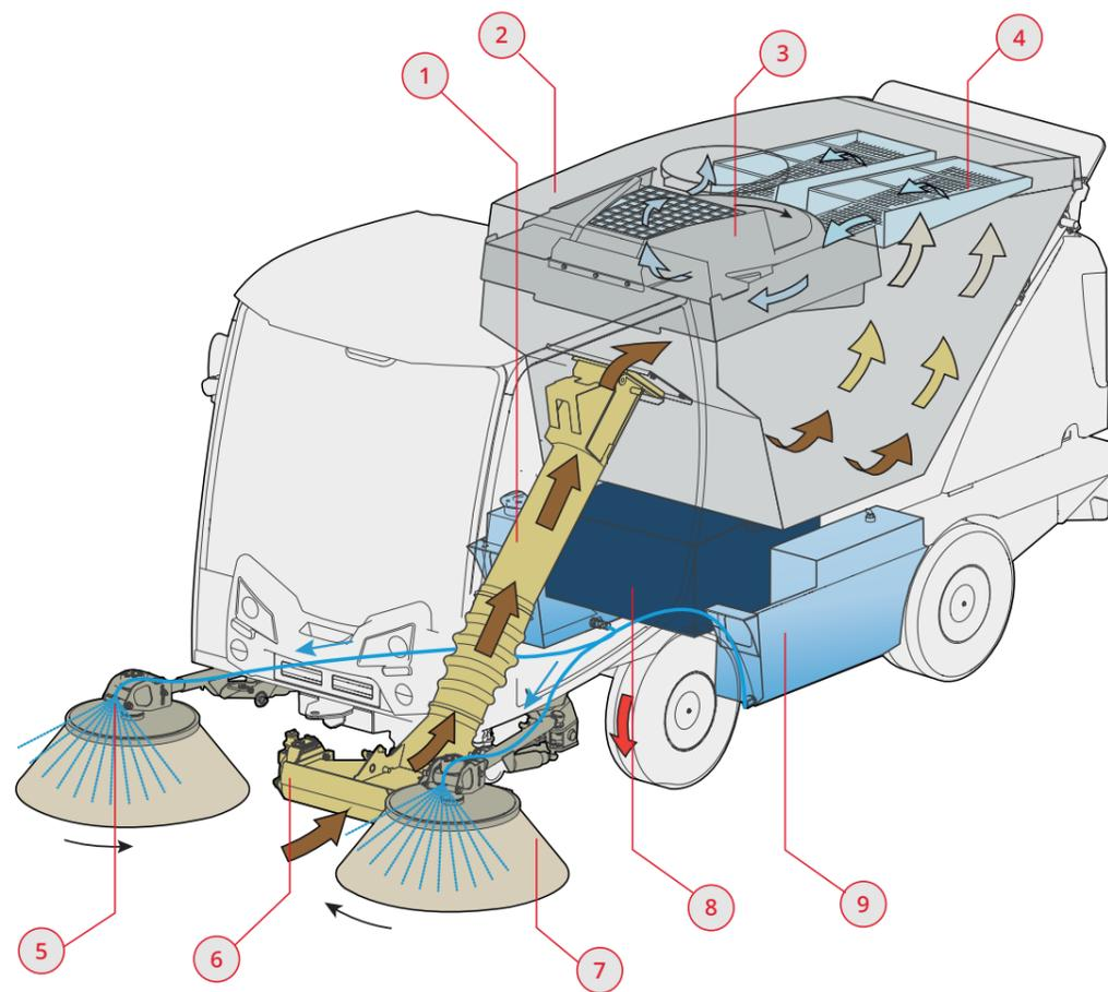
1 Saugschlauch mit Wasserdüsen zur Staubbindung
