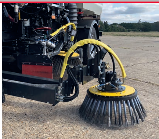
Cepillo de deslizamiento lateral Cepillo opcional detrás de la rueda delantera para aumentar la anchura de barrido y eliminar eficazmente las malas hierbas sin utilizar productos químicos.
