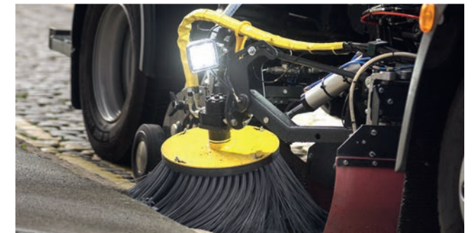
Luces de trabajo triples del equipo de barrido Luces de trabajo LED para iluminar el lateral de la barredora y el bordillo.
