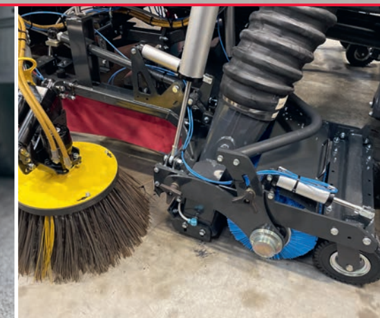
Broomvak equipo de barrido Para la recogida a alta velocidad. También permite la captación con una potencia de ventilador reducida en aplicaciones menos exigentes.
