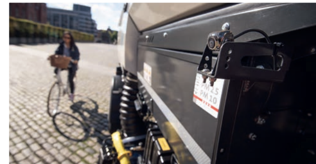
Cámara Quad Para obtener una vista lateral fuera de la carretera y ofrecer una visión adicional para posibles puntos ciegos.
