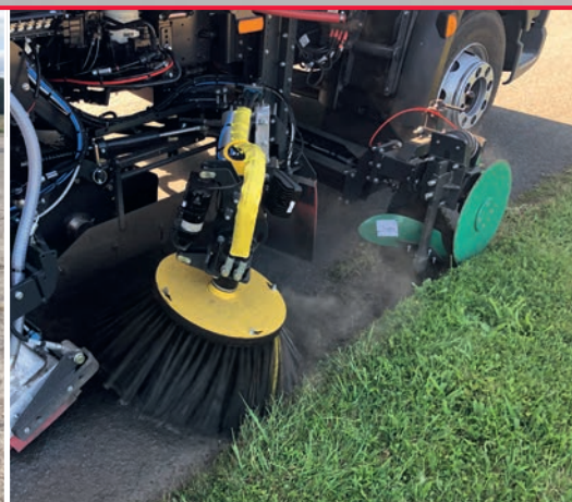
Opción de disco de corte Ofrece la posibilidad de reducir la entrada de césped en carreteras sin bordillo y proporciona un borde de corte limpio a los arcenes.
