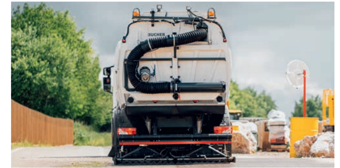
Mangote trasero Manguera hidráulica de alta resistencia de 200 mm de diámetro, montada en la puerta trasera, especialmente útil para su uso en zonas con restricciones de altura.
