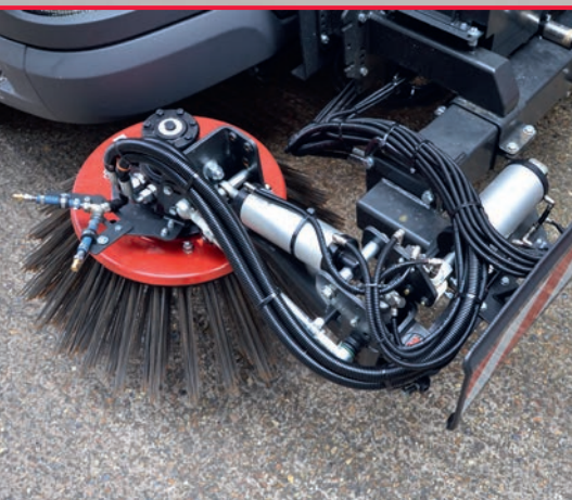
Opción de cepillo frontal Cepillo desbrozador de 700 mm en un brazo telescópico para un largo alcance de 1000 mm con control en cabina.
