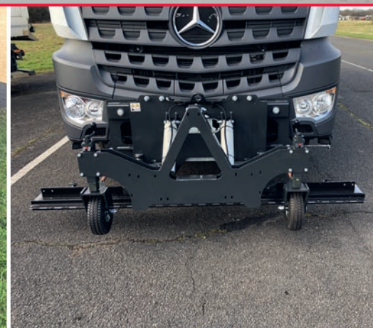
Imán frontal Opción para la recogida y eliminación de material férrico en aplicaciones de limpieza aeroportuaria e industrial.
