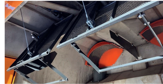
Elevación remota de la rejilla Permite bajar y subir las rejillas de la tolva a distancia, sin necesidad de que el operario se sitúe en la zona sucia.
