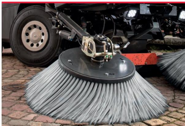
I bracci delle spazzole includono attenuatori d'urto anteriori e ammortizzatori idraulici per gli urti laterali, riducendo così i costi correlati ai danni. Un perno di sicurezza che può essere agevolmente sostituito dall'operatore protegge i bracci delle spazzole e il telaio da costose riparazioni.
