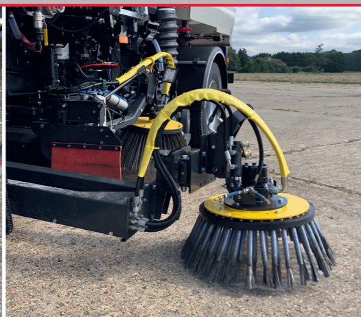
Balai à coulissement latéral Balai en option derrière la roue avant pour une plus grande largeur de balayage et un désherbage efficace sans utiliser de produits chimiques.
