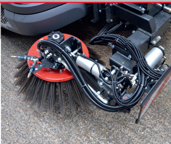
Balai avant en option Balai désherbant de 700 mm sur un bras télescopique pour une portée allant jusqu'à 1 000 mm avec commande en cabine.
