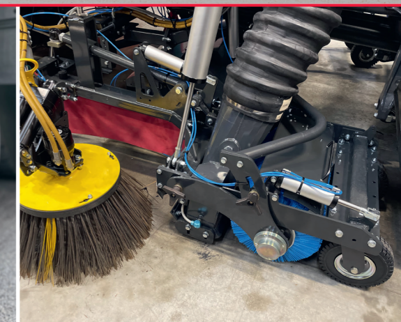
Équipement de balayage Broomvak Pour un ramassage à grande vitesse. La conception du balai derrière la buse permet également un ramassage à une puissance de turbine réduite pour des applications moins exigeantes.
